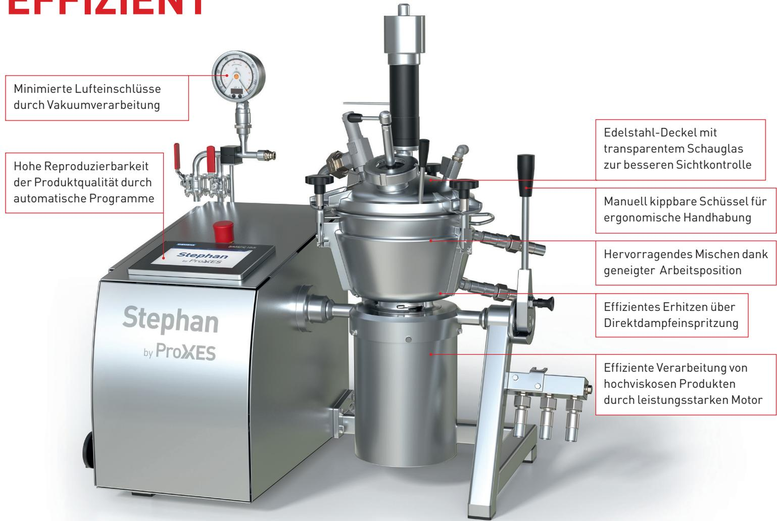
Mit der UMX 5S haben wir den Anwendungsbereich unseres Basismodells UMX 5 weiter ausgebaut. Dank ihrer Direktdampfeinspritzung, wodurch die Produkte schnell auf max. 110 °C erhitzt werden, kann die UMX 5S auch für die Herstellung von Schmelzkäse eingesetzt werden. Ihre Effizienz, Schnelligkeit und Flexibilität machen die UMX 5S zum perfekten Allrounder für ein breites Spektrum von Labor- und F&E-Anwendungen.
